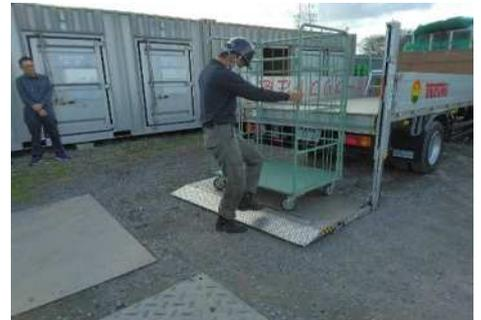
また法改正に伴い、23年10月からは「昇降設備の設置」と「作業する際の保護帽の着用」が義務付けられたため、車両に昇降設備（可搬式足場台）を追加で設置、作業手順書への追記を行いました。荷下ろし時の安全確保に努めます。
